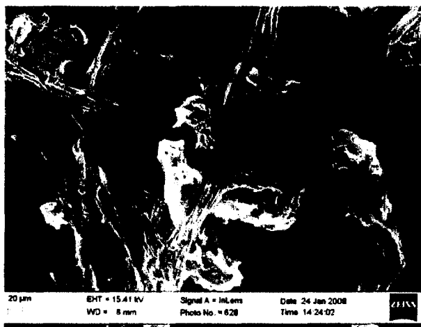
Figura 3.3. - Flocchi di RECAM® con fibre di crisotilo attaccate sulla superficie.
